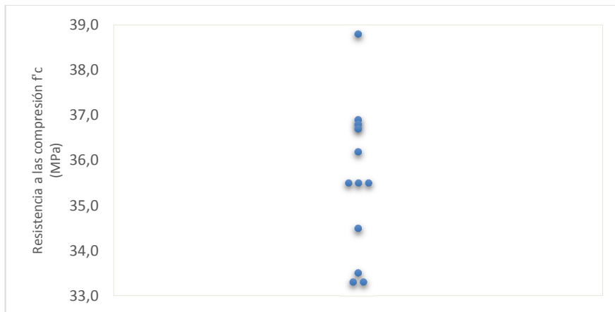
Gráfico 1-2. Dispersión de los resultados para el ensayo de resistencia a la compresión uniaxial de cilindros de concreto de 100 mm x 200 mm, a los 28 días
