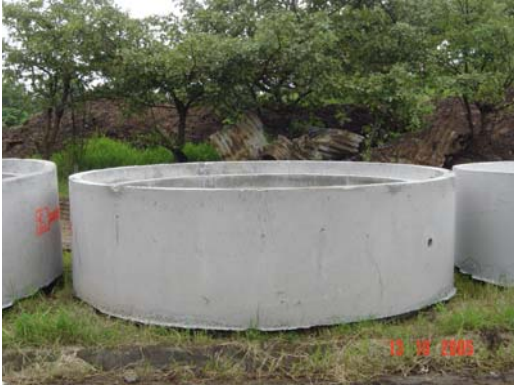
Fotografía 16. Tubería de concreto empleada
